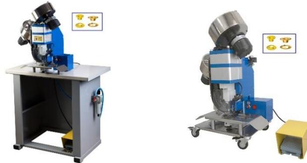
Vollautomatische, pneumatische Ösenmaschine für Metall Ösen und Sicherheitsringe. Platziert Ösen und Sicherheitsringe in alle Arten von Materialien: Textil, Karton, Leinwand, PVC, usw.
