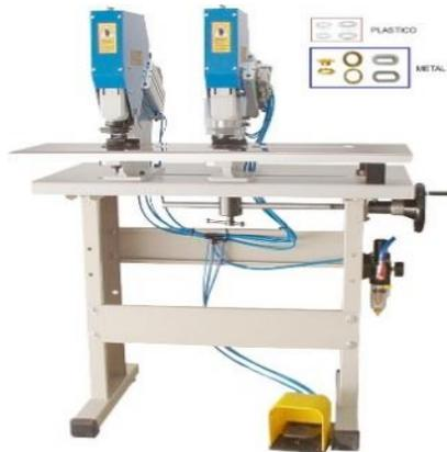
**Pneumatische Ösenmaschine, mit Doppelkopf und Tisch, für das Einsetzen von Metallösen, geeignet bis zu 40 mm Innendurchmesser.**
