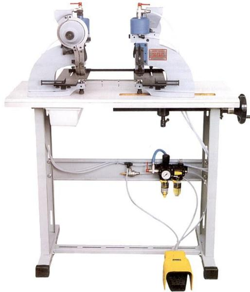
Automatische, pneumatische Maschine mit Doppelkopf, zum Einsetzen von Nieten in Ordner. Platziert die Nieten in alle Typen von Materialien: Schuhe, Kunststoff, Textil, Karton, Leinwand, PVC usw. Verstellbare Seite und vorn Führungen, um die Ordner zu platzieren.
